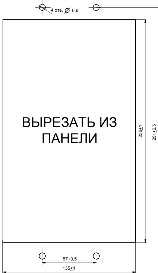
Рисунок А.12 Установочные размеры ТЭМП 2501-13
